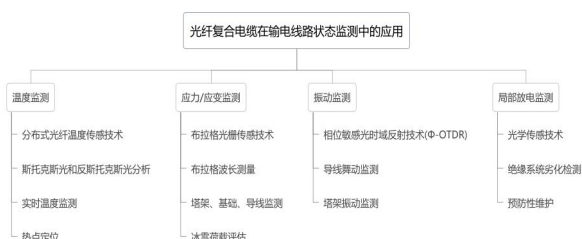
图 1：光纤复合电缆在输电线路状态监测中的应用导图
