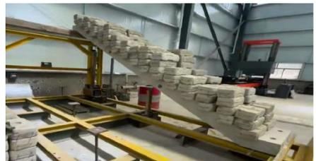
图 3.2.3-2 预制楼梯承载力试验
