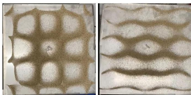
图 3 左图和右图分别是在频率为 584Hz 和 601Hz、波幅为 20V 的喇叭信号条件下形成的克拉尼图形。
