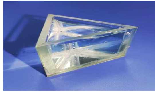
图 5 自制直角三棱镜容器
