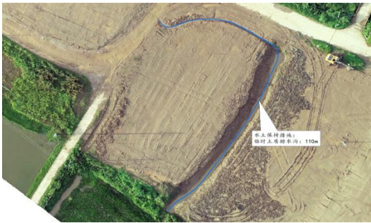
图 3 已实施的临时排水沟解译量测
