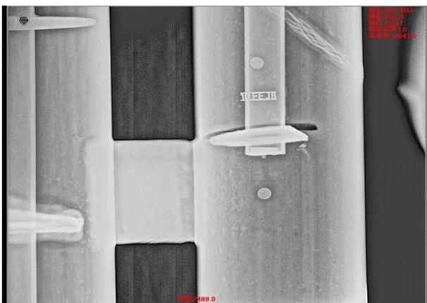
图3 7-1组折流板划伤内冷管（右侧）
