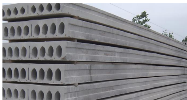
图1 预应力钢筋混凝土
