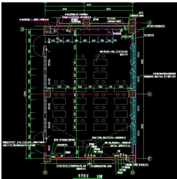
具体配置黑板，讲台，讲桌，清洁柜软扎板，空调，窗帘杆，于教室的后部设置成品不锈钢洗池或采用后做洗池，地漏等，需考虑相应科学教室下部房间的功能，因科学教室设置水池，地漏等，在漏水情况下势必对下层造成影响，因此科学教室下层不能设置强电，弱电，
