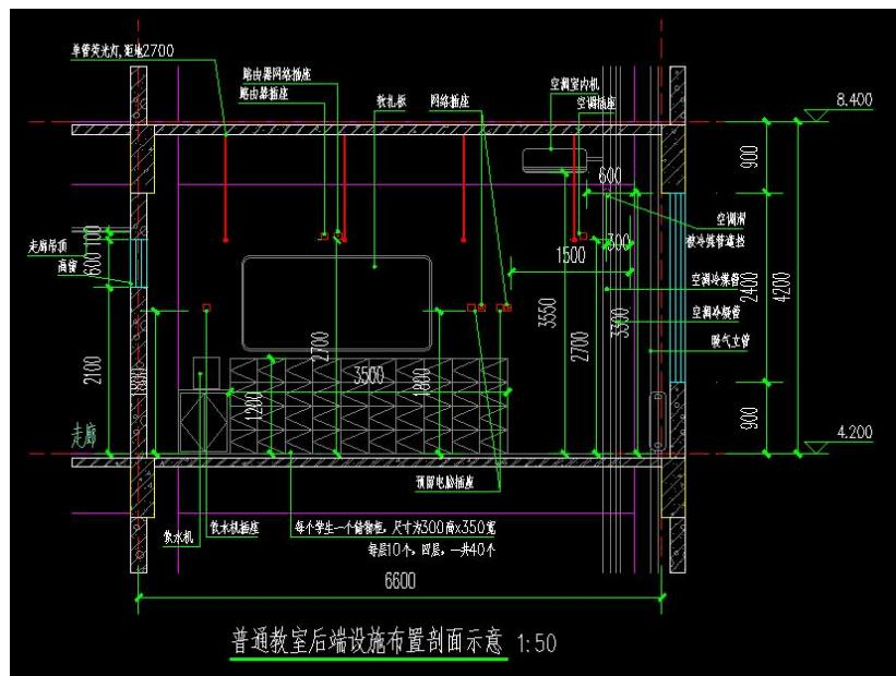
黑板距离讲台的高度小学要求 0.8-0.9 米，中学要求 1.0-1.1 米，黑板表面应采用耐磨，无光泽材料。教室与教室水平之间，以及上下教室之间均应考虑相互之间的声音干扰，在教室之间墙体做隔声处理，上下教室之间采用隔声楼板。
