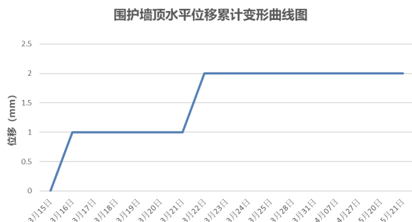
图 16 围护墙顶水平位移累计变形曲线图
