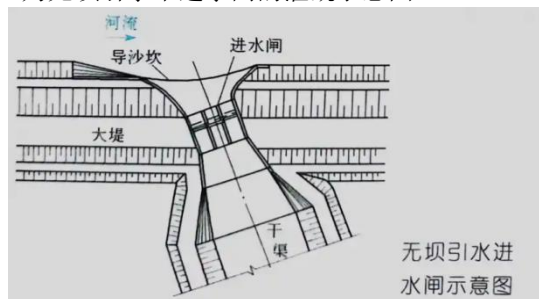
图1 无坝引水中进水闸的灌溉示意图
