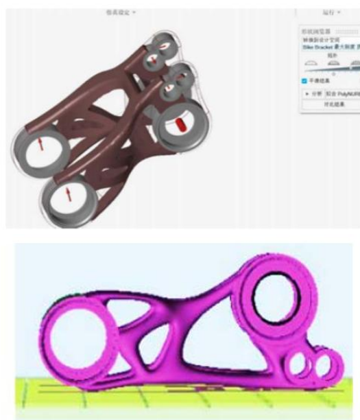
图 6 拓扑优化及轻量化设计输出模型子模型
