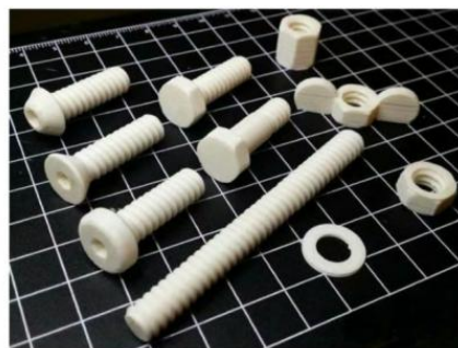
图 5 螺栓 SolidWorks STL 导出及 3D 打印
