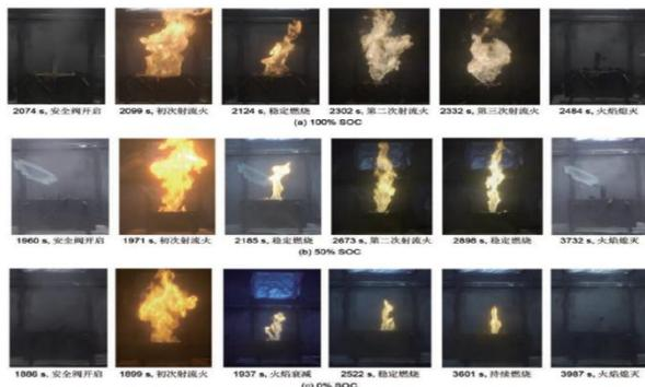
磷酸铁锂电池不同荷电状态(SOC)下的燃烧试验过程图
