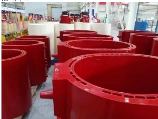
图 4 采取措施后批量浇注的线圈
