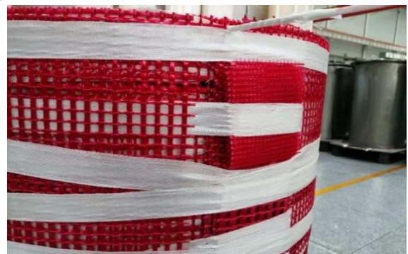
图 2 引线处加垫网格布
