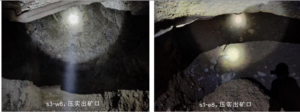
图4 出矿口压实型黏结卡斗照片
