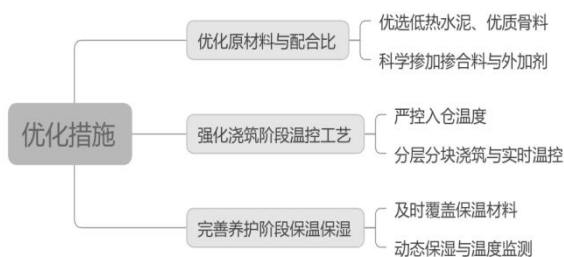
图1 水闸大体积混凝土温控优化措施
